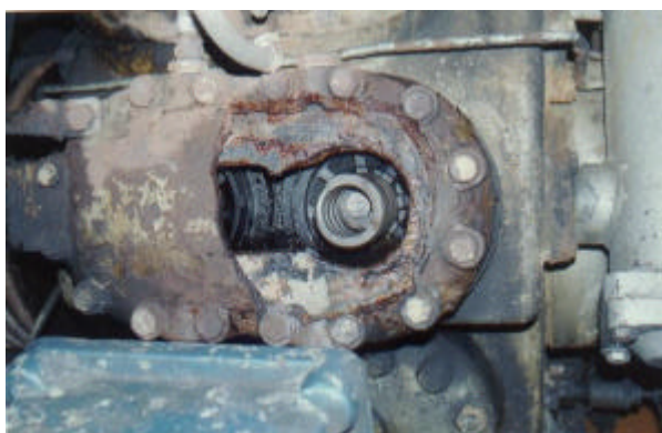
Figuras 10 e 11 – Tampa do compressor rompida
