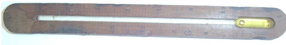
**FIGURA 3-** Termômetro a álcool (corante amarelo) na escala Celsius (1872). .A escala (-10/+50 °C) é gravada na madeira, onde se insere o tubo e o bulbo de vidro na cavidade central (Foto da Instituição).
