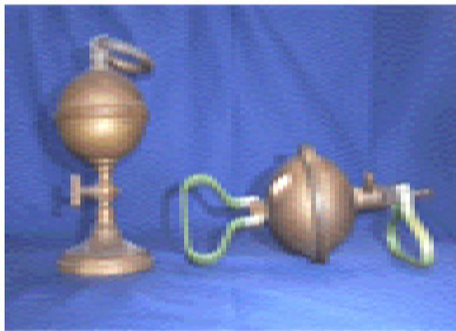
**FIGURA 9-** A Esfera de Magdeburgo (1880) comparada com uma mais moderna (1960), à direita (Foto da Instituição). Disponível em: <<http://server2.iq.ufrj.br/museu/equipamentos.html>>. Acessado em: 23 jan. 2010.
