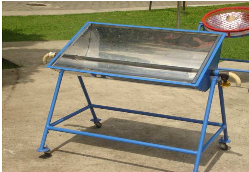
Figura 4.5 Equipamento para aquecer água usando energia solar localizado na Praça Solar – Parque da Ciência
