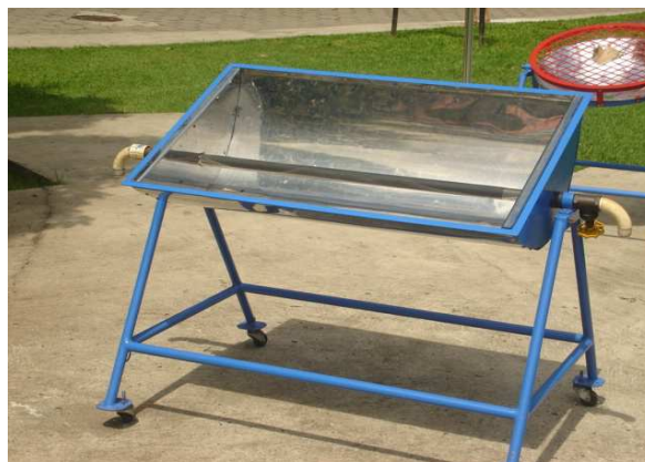
Foto 5.17 Aquecedor solar para água
